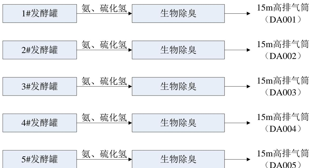
图 6.2-1 有组织废气处理工艺流程图
