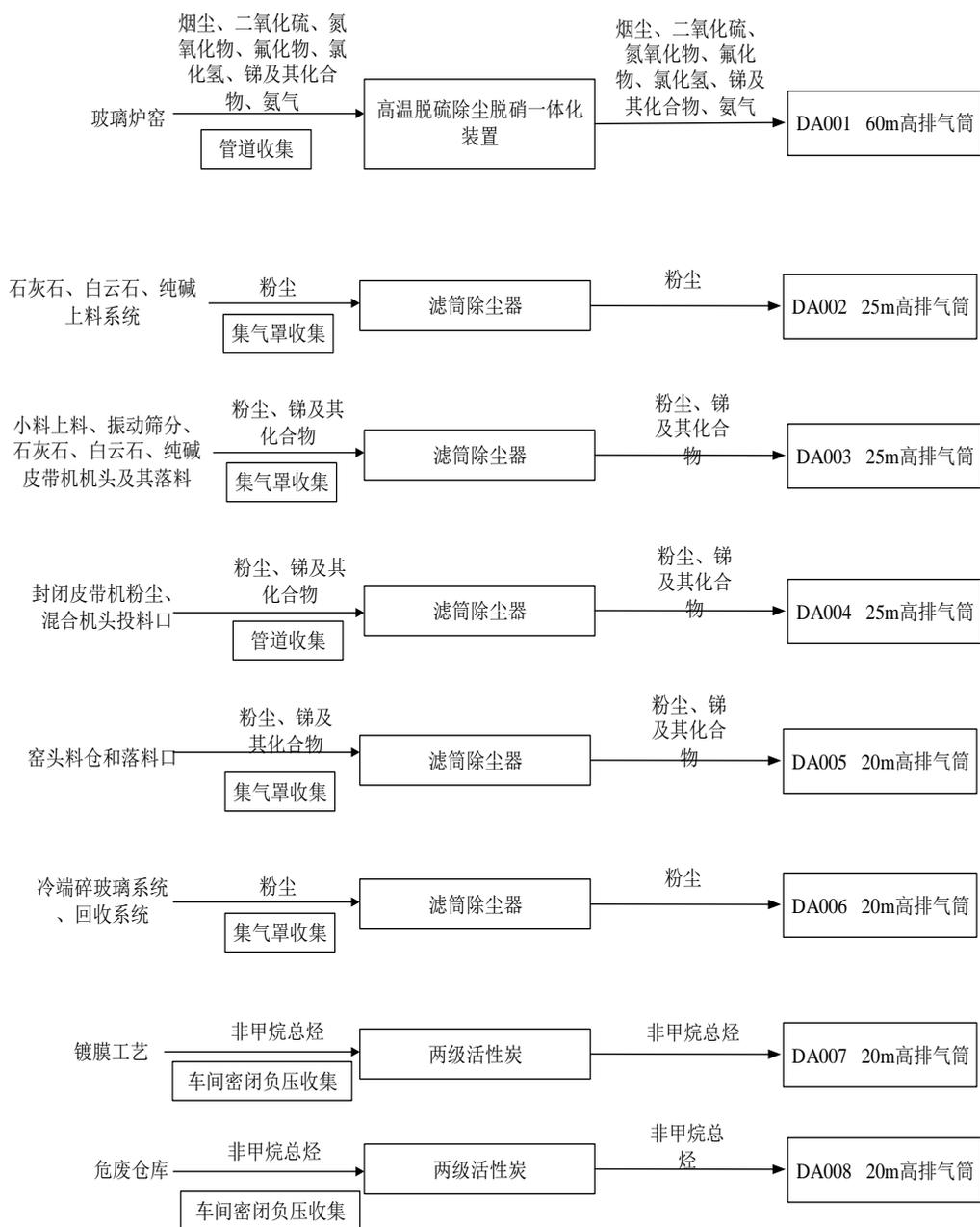
图 1.2-1 变动前本项目有组织废气走向图
