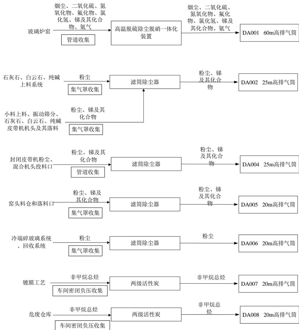
图 1.2-2 变动后本项目有组织废气走向图
