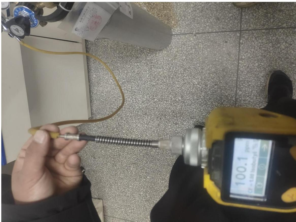
图 7.2-1 PID 校准
