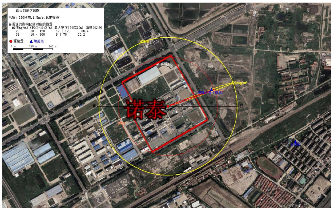
图 6.8-6 乙腈储罐泄漏火灾爆炸次生/伴生 \text{NO}_2 最不利气象条件下毒性浓度影响范围图
