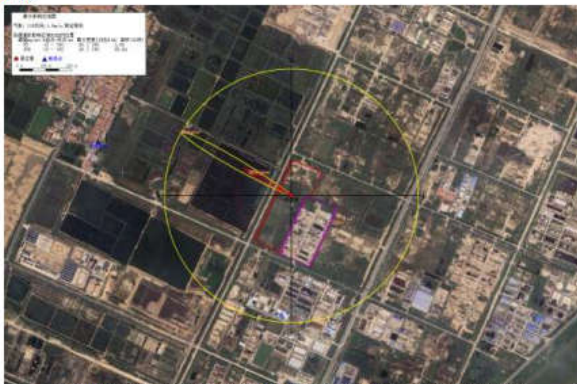
图 6.8-3 乙醛泄漏火灾次生污染物 CO 最不利气象条件下毒性浓度影响范围图
